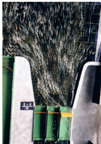
RYSUNEK 9.2. Widok prądów powierzchniowych na modelu jazu przy przepływie przez jedno skrajne przęsło; kierunek przepływu pokazuje strzałka [Majewski 2003]
