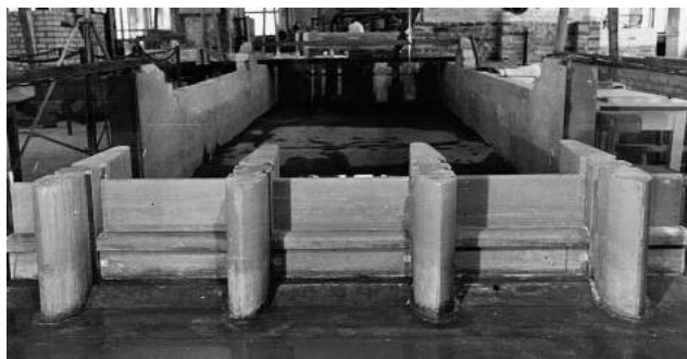
RYСУNEK 9.14. Model jazu stopnia Włocławek w budowie (skala 1:50); trzy przęsła jazu wraz z podniesionymi zasuwanami (widok od strony wody górnej) [IBW PAN 1959a]
