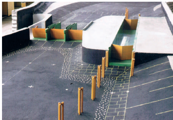
RYSUNEK 9.1. Model stopnia wodnego z jazem trzyprzęsłowym oraz śluzą, gotowy do badań – kierunek przepływu pokazuje strzałka [Majewski 2003]
