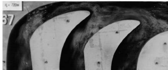
Skorygowany kształt wlotów do galerii śluzy żeglujowej
