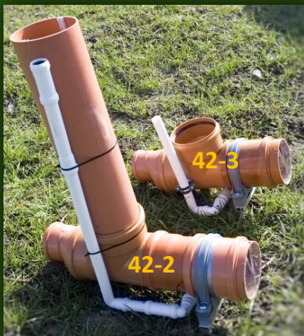
Tymczasowe urządzenia pomiarowe i piętrzące zainstalowane w dziale drenarskim 42.2 (ze wstrzymywaniem odpływu) i 43-3 (kontrolnym), 1 marca 2019 Dodatkowe urządzenie zainstalowano też w dziale drenarskim 42-1.
