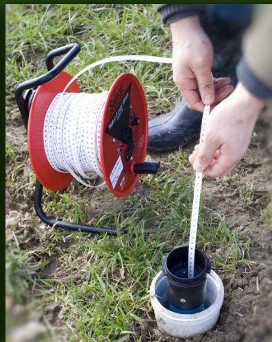
Instalacja studzienek i mierników do poziomu zwierciadła wody gruntowej 42.2 (ze wstrzymywaniem odpływu) i 43-3 (kontrolnym), 27 lutego 2019
