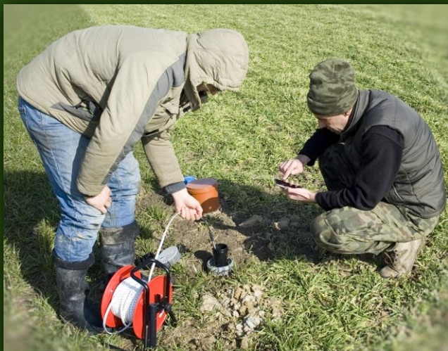
Instalacja studzienek i mierników do poziomu zwierciadła wody gruntowej 42.2 (ze wstrzymywaniem odpływu) i 43-3 (kontrolnym), 27 lutego 2019
