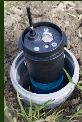
Instalacja studzienek i mierników do poziomu zwierciadła wody gruntowej 42.2 (ze wstrzymywaniem odpływu) i 43-3 (kontrolnym), 27 lutego 2019
