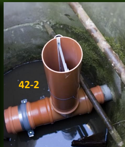
Tymczasowe urządzenia pomiarowe i piętrzące zainstalowane w dziale drenarskim 42.2 (ze wstrzymywaniem odpływu) i 43-3 (kontrolnym), 1 marca 2019 Dodatkowe urządzenie zainstalowano też w dziale drenarskim 42-1.
