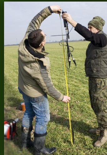
Instalacja studzienek i mierników do poziomu zwierciadła wody gruntowej 42.2 (ze wstrzymywaniem odpływu) i 43-3 (kontrolnym), 27 lutego 2019
