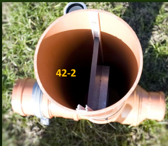
Tymczasowe urządzenia pomiarowe i piętrzące zainstalowane w dziale drenarskim 42.2 (ze wstrzymywaniem odpływu) i 43-3 (kontrolnym), 1 marca 2019 Dodatkowe urządzenie zainstalowano też w dziale drenarskim 42-1.
