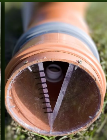
Tymczasowe urządzenia pomiarowe i piętrzące zainstalowane w dziale drenarskim 42.2 (ze wstrzymywaniem odpływu) i 43-3 (kontrolnym), 1 marca 2019 Dodatkowe urządzenie zainstalowano też w dziale drenarskim 42-1.
