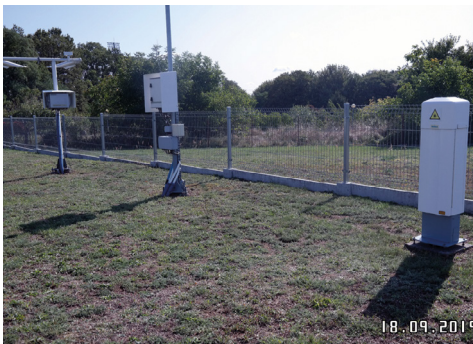
Rysunek 48. Stacja automatyczna MAWS 301 z czujnikiem widzialności (po lewej stronie) oraz czujnikiem wysokości podstawy chmur (po prawej stronie) w ogródku meteorologicznym stacji Zielona Góra [fot. D. Szkolniak]
