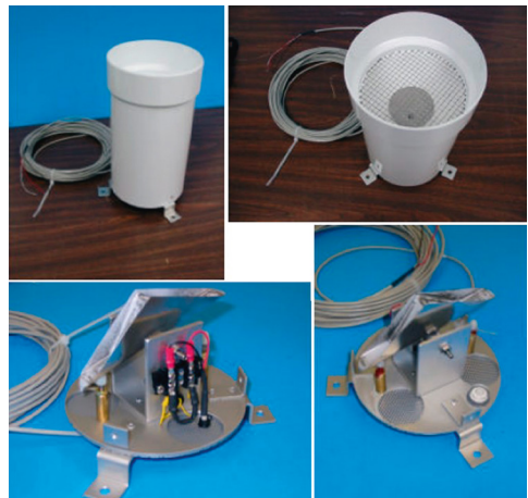
Rys. 3.5. Elektroniczny deszczomierz korytkowy firmy Met One Instruments 60030
