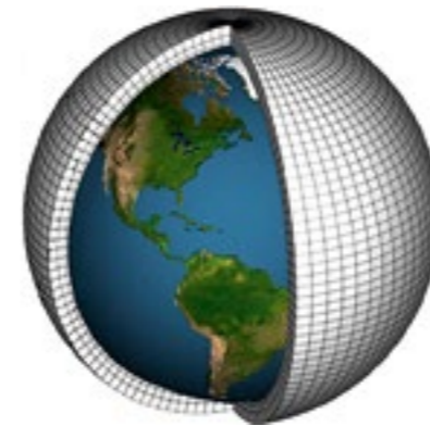
W modelach klimatyczno-prognostycznych planetę dzieli się na siatkę z odstępami pionowymi i poziomymi – takie rozwiązanie zastosowano m.in. w globalnym modelu GCM; im mniejsze odstępki, tym drobniejsza siatka i lepsza rozdzielczość modelu, co oznacza, że „zauważa” on więcej szczegółów (źródło: NOAA)
