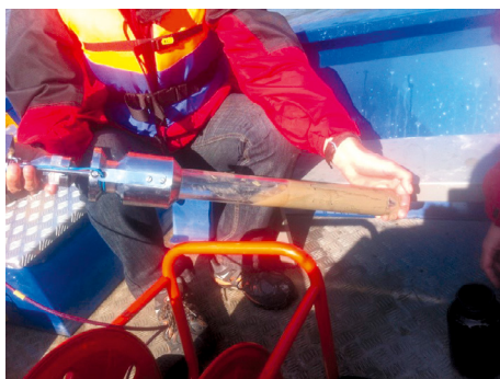
Pobieranie osadów dennych próbnikiem rdzeniowym Nurek do badań chemicznych (fot. archiwum CTKZ).
