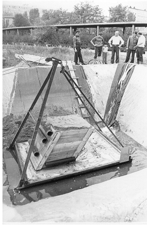
Stanowisko terenowe do badania poślizgu gruntu po folii (fot. archiwum CTKZ).
