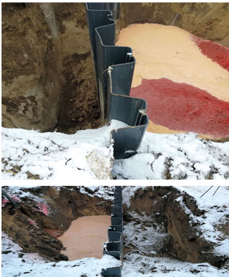
Rys. 8. Zdjęcie z próby szczelności grodziec winylowych.
