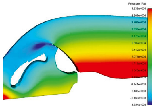
Rys. 6. Poglądowa prezentacja danych uzyskanych z rozwiązania numerycznego modelu klapy jazu Stopnia Wodnego Ujście Nysy dla wybranego scenariusza obliczeniowego: scenariusz nr 1 – widok na układ strug przelewającej się wody wraz rozkładem ciśnienia.
