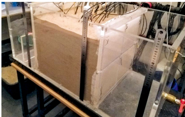
Rys. 2. Model fizyczny do badania filtracji (fot. A. Budzianowska).
