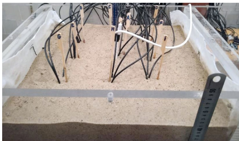
Rys. 3. Model fizyczny do badania filtracji – widok na napełnioną komorę badawczą (fot. A. Budzianowska).
