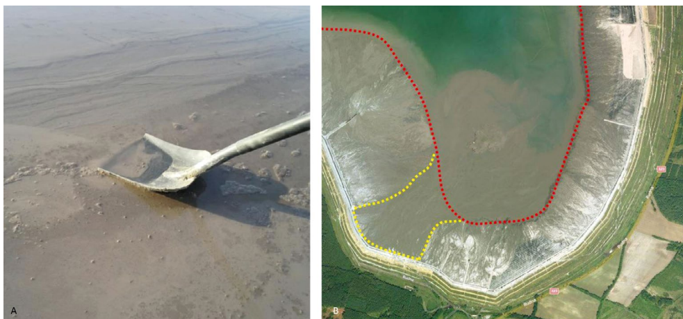
Rys. 4. Czysta woda kilka minut po zaprzestaniu wypełniania poletka próbnego (a); sekcja namywana (kolor żółty) z zaznaczeniem umownej granicy plaża/akwen (kolor czerwony) i widoczną strefą oddziaływania namywu (b)
