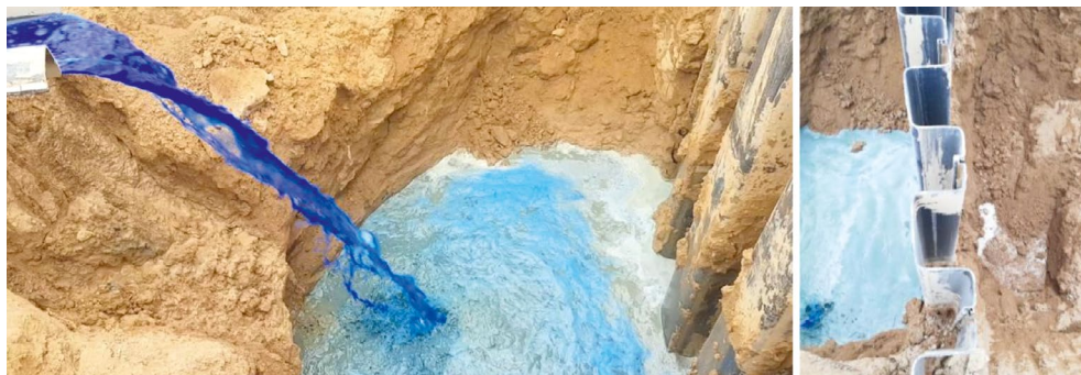
Rys. 11. Zdjęcia z próby po odkopaniu 4 m i wlewaniu zabarwionej wody.
