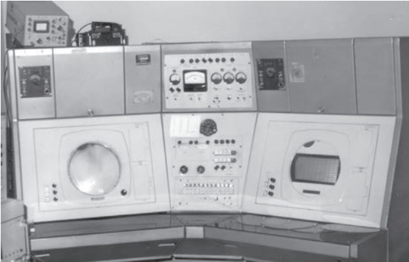
Rys. 3.2. Konsola operatorska radaru MRL-2: po lewej stronie konsoli wskaźnik typu P , a po prawej wskaźnik typu RH , pośrodku wskaźniki stanu technicznego radaru
