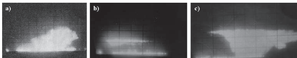
Rys. 3.4. Zobrazowanie przekrojów pionowych na wskaźniku RH: a) echa od chmur konwekcyjnych typu cumulonimbus , b) echa od chmur konwekcyjnych typu cumulonimbus capillatus , c) echa warstwowe (przyziemne i podniesione) [Moszkowicz, Woronow 1977]
