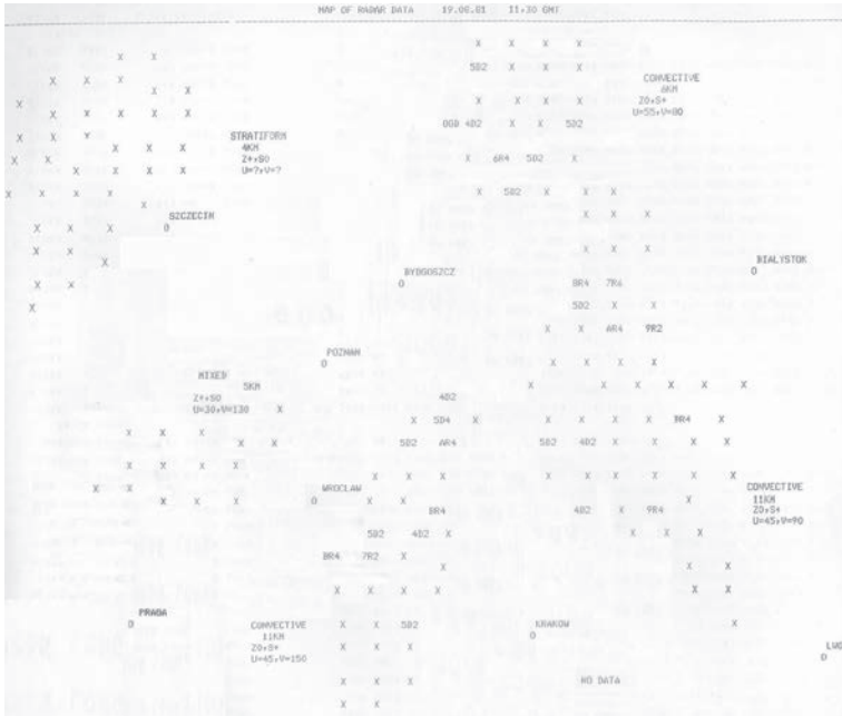
Rys. 6.4. Zobrazowanie mapy zbiorczej utworzonej z danych radarowych (Polska, NRD, CSRR, ZSRR) i synoptycznych – wykonane na MERA400 i wydrukowane na drukarce DZM – 180 (X – echo bez zjawisk, R – burza, D – opad przelotny, z lewej strony zjawiska – wysokość wierzchołka echa) [Moszkowicz 1981]
