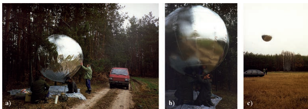
Rys. 5.22. Kalibracja radaru w Legionowie za pomocą tarczy wzorcowej w kształcie balonu: a) przygotowywanie balonu (napełnianie gazem), b) mocowanie balonu do linki, c) balon wznosi się na uwięzi
