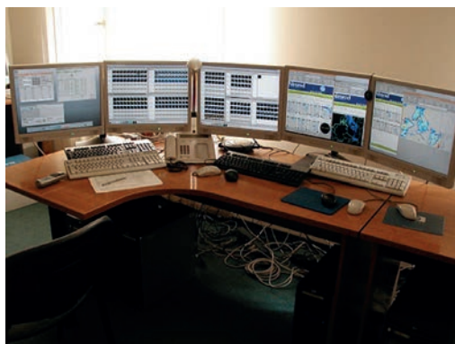
Rys. 9.28 Stanowisko operatorskie do obsługi systemu radarowego i NIMROD
