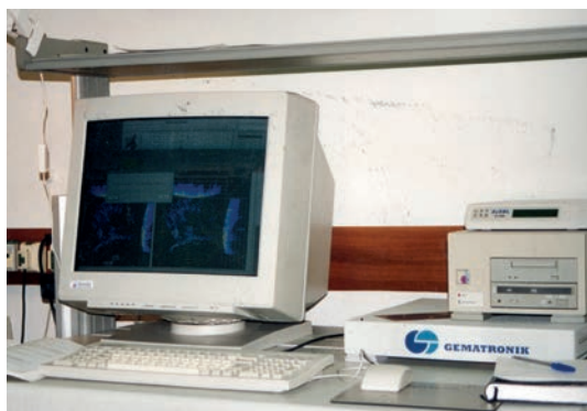
Rys. 7.5. Stanowisko sterowania pierwszym radarem dopplerowskim (lata 1995-1999) w Oddziale Katowickim, fot. Ryszard Klejnowski
