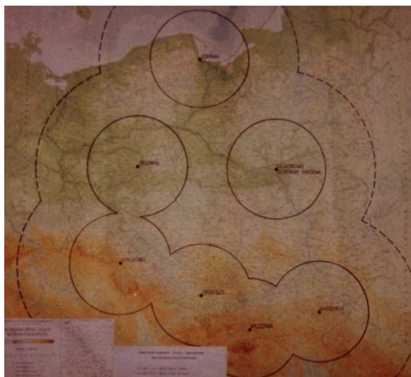
Rys. 6.6. Zasięg sieci radarowej, dla strefy bliskiej i dalekiej, utworzonej z siedmiu lokalizacji opartych na założeniach z roku 1989
