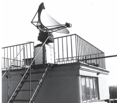
Rys. 2.3. Antena nadawczo-odbiorcza radaru DECCA 41. Źródło: zdjęcie ze zbiorów Ośrodka Aerologii
