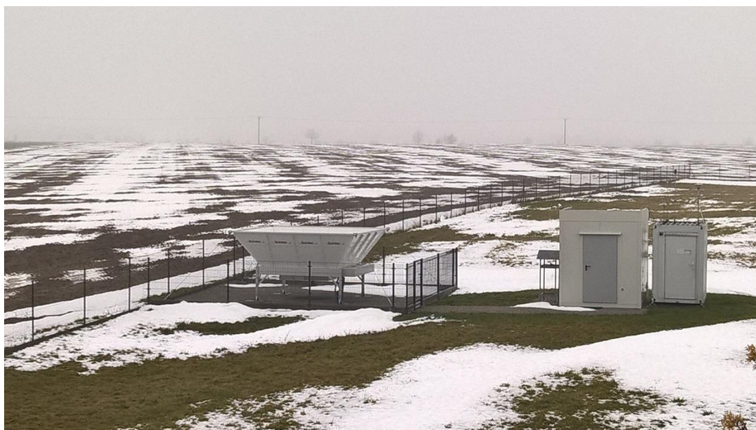
Widok anteny nadawczej WP LAP3000 w ogródku meteorologicznym w Raciborzu
