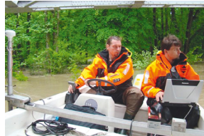
HYDROMETRISCHE MESSUNGEN NACH DEM ADCP-RIO-GRANDE-VERFAHREN AN DER ODER OBERHALB DES PEGELS TRESTNO [Maciejewski et al. 2010]
