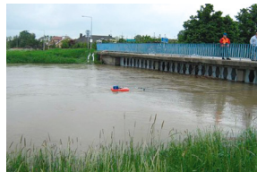
HYDROMETRISCHE MESSUNGEN MIT MESSFLÜGEL VON EINER BRÜCKE ÜBER DEN FLUTKANAL IN BRESLAU AUS [Maciejewski et al. 2010]
