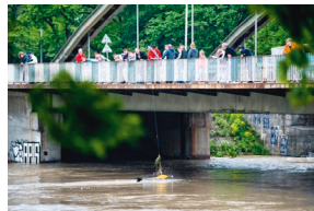
HYDROMETRISCHE MESSUNGEN NACH DEM ADCP-STREAM-PRO-VERFAHREN IN KRZYŻANOWICE AN DER WEIDE [Maciejewski et al. 2010]
