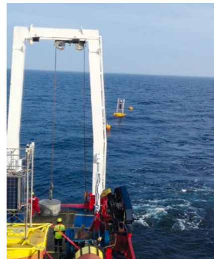
Ostatnia faza rozstawiania boi, tj. rozciąganie systemu kotwicznego i opuszczanie drugiej kotwicy. Na rufie statku na bramownicy podczepiona kotwica gotowa do opuszczenia.
